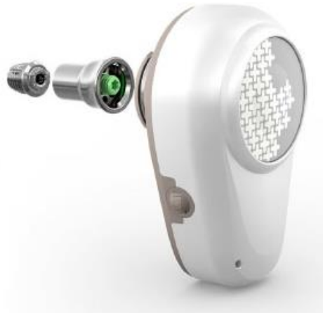
Figuur 1. De drie onderdelen, van links naar rechts: het implantaat, het abutment en het BCD.
